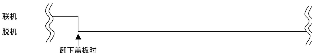
如果在打印期间，卸下打印机盖板，打印机将进入脱机状态导致错误。
