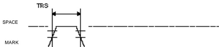
图 2.1.1 最小复位脉冲宽度 (引脚 6)
