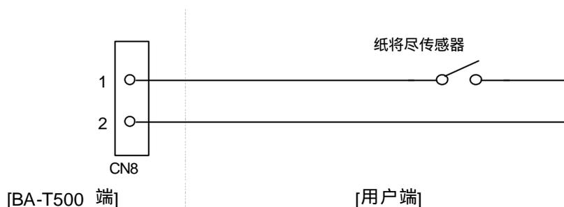
用户端连接器类型: Housing: IL-S-2S-S2C2-S (JAE)
